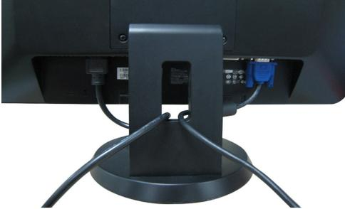
将所有必要的电缆连接到显示器和计算机后（请参阅[连接显示器](#)了解如何连线），请如下所示使用电缆管理夹将所有电缆整齐的整理在一起。
